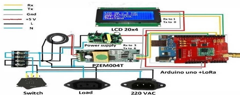
ภาพที่ 7 การต่อวงจรชุด LoRa Gateway
