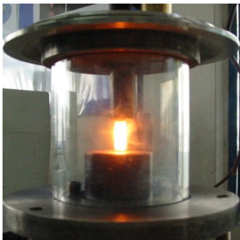
ภาพที่ 2 แท่งสารขณะทำการสังเคราะห์เส้นใยนาโนซิลิกาโดยเทคนิคการให้ความร้อนด้วยกระแสไฟฟ้า
