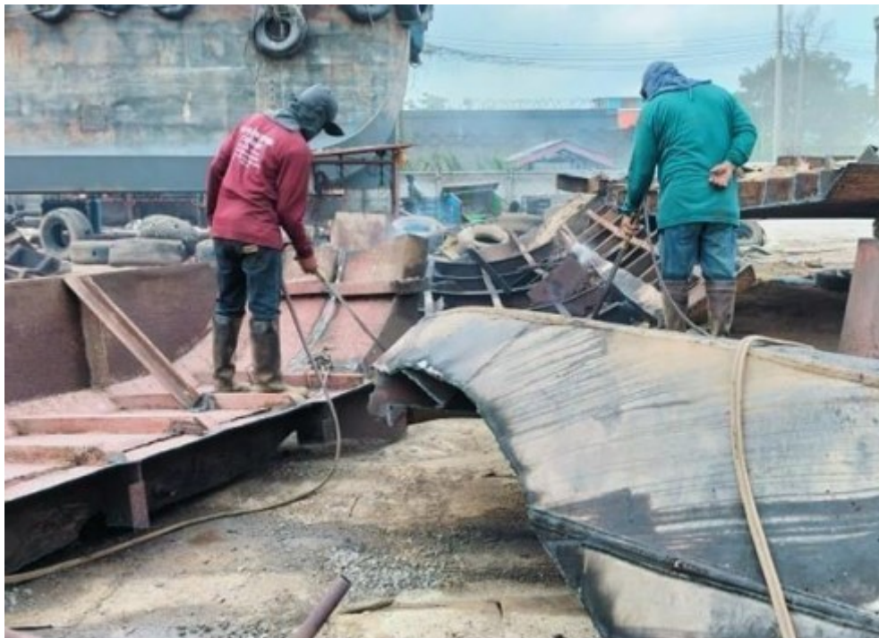
ภาพที่ 1 กระบวนการเชื่อมแผ่นใต้ท้องเรือ
