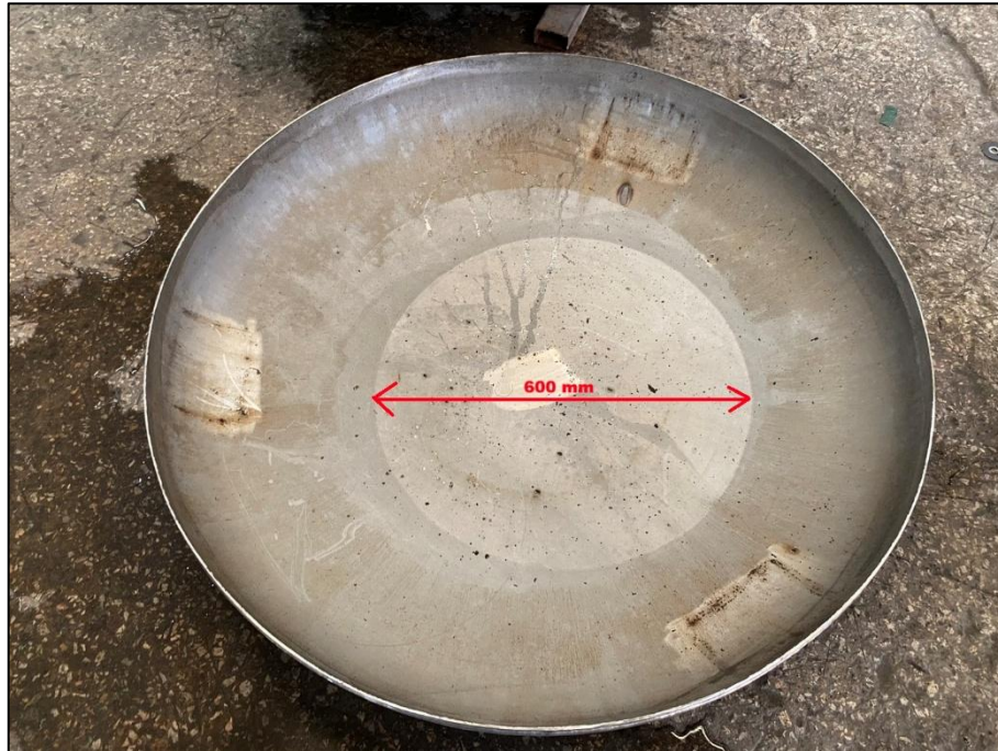
ภาพที่ 2 ลักษณะกันถังและขอบเขตพื้นที่วิกฤตกรณีศึกษาเส้นผ่านศูนย์กลาง 600 มม. ที่ตรวจพบการกัดกร่อนแบบรูเข็ม (ด้านในถัง)
