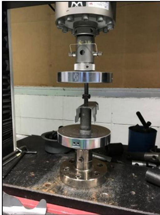
ภาพที่ 3 การทดสอบแป้นเกลียวเชื่อมด้วยแรงดึงของลูกค้ำตามมาตรฐาน TSB1503G
