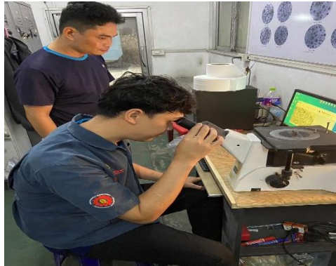
ภาพที่ 7 ดูโครงสร้างจุลภาคของเกรนด้วยกล้องจุลทรรศน์ MICROSCOPE MODEL : JAPAN 258203
