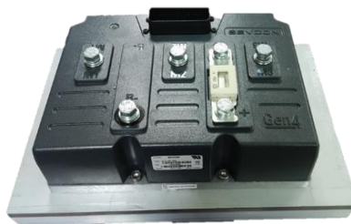
ภาพที่ 3 อุปกรณ์ควบคุมมอเตอร์ไฟฟ้าแบบอินดักชัน (IM)
