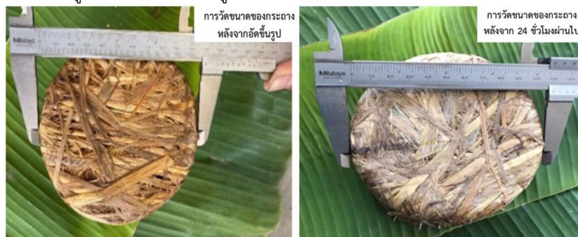
ภาพที่ 5 การตรวจสอบค่าการคืนตัวของกระถางที่ขึ้นรูปโดยใช้เครื่องอัดขึ้นรูปกระถางด้วยฟางข้าว
