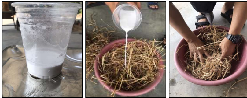
ภาพที่ 2 การเตรียมวัตถุดิบสำหรับการอัดขึ้นรูปกระถางด้วยฟางข้าว
