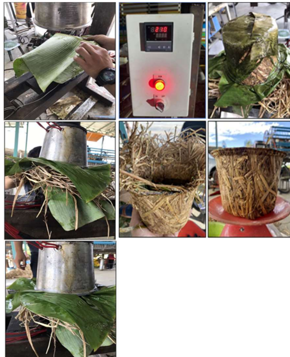
ภาพที่ 3 การเตรียมใบตองสดและการอัดขึ้นรูปกระถางด้วยฟางข้าว
