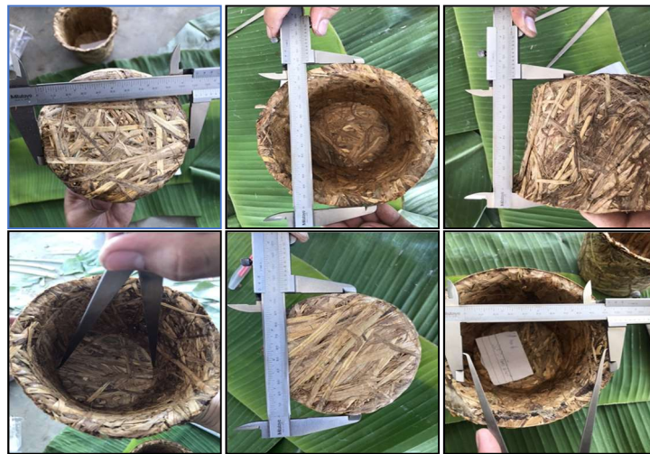
ภาพที่ 4 การตรวจสอบกระถางที่ผ่านกระบวนการอัดขึ้นรูปด้วยฟางข้าว
