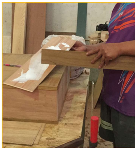
ภาพที่ 7 ตัวอย่างการใช้กาวไทท์บอนด์ (Titebone) เพื่อประกอบชิ้นงานในสถานะหลังปรับปรุง
