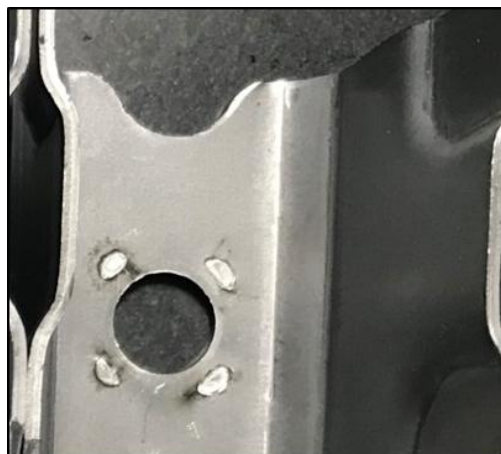
ภาพที่ 2 ลักษณะแป้นเกลียวเชื่อมหลุดของผลิตภัณฑ์คานรองรับกระเบ
