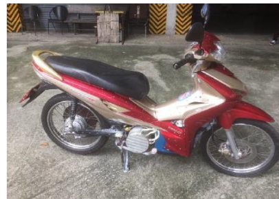
ภาพที่ 6 มอเตอร์ชุดขับเคลื่อนและแบตเตอรี่ที่ติดตั้งเข้ากับจักรยานยนต์ไฟฟ้า
