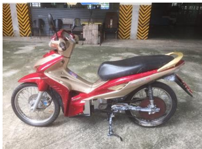
ภาพที่ 6 มอเตอร์ชุดขับเคลื่อนและแบตเตอรี่ที่ติดตั้งเข้ากับจักรยานยนต์ไฟฟ้า
