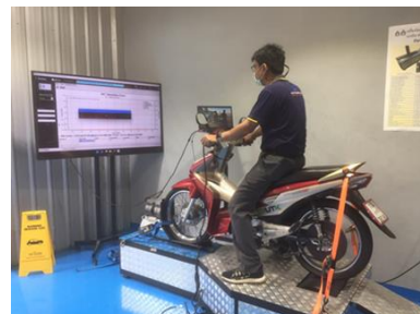
ภาพที่ 7 การทดสอบสมรรถนะของจักรยานยนต์ไฟฟ้าดัดแปลงบนไดนาโมมิเตอร์
