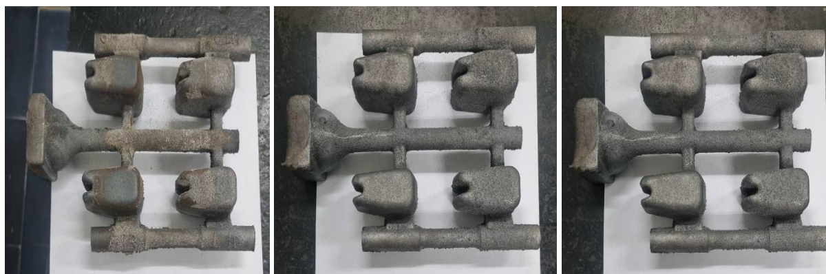
ก ข ค ภาพที่ 4 ชิ้นงานหลังหลอมเสร็จ ก.คาร์บอน 3.0% ข.คาร์บอน 3.5% , ค.คาร์บอน 4.0%
