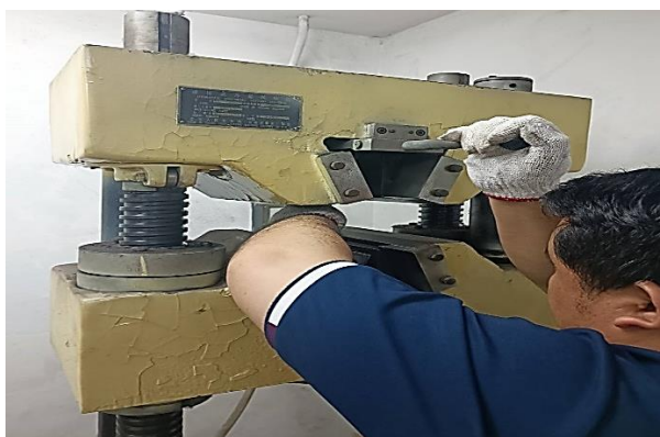
ภาพที่ 5 ทดสอบชิ้นงานตัวอย่างด้วยเครื่อง TENSILE TESTING MACHINE MODEL : WE 300B (W10-277)
