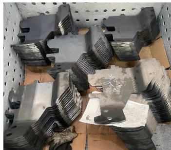
ภาพที่ 6 ลักษณะชิ้นงานที่จบกระบวนการพับและบรรจุลงในพาเลท
