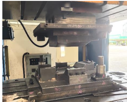
ภาพที่ 14 การทดสอบแม่พิมพ์
