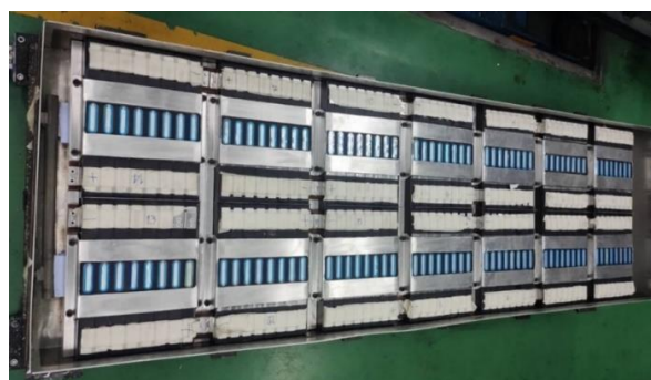
ภาพที่ 6 แบตเตอรี่ลิเทียมไอออน NMC Pack (8P14S) พิกัดแรงดันไฟฟ้าขนาด 48 V
