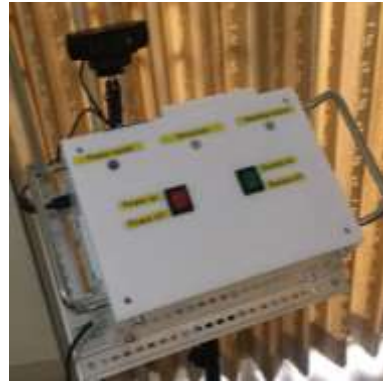
ภาพที่ 3 เครื่องตรวจจับการเคลื่อนไหวด้วยการประมวลผลภาพ
