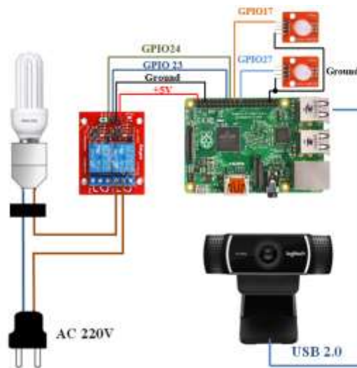
ภาพที่ 7 ระบบตรวจจับการเคลื่อนไหววัตถุด้วยการประมวลผลภาพ
