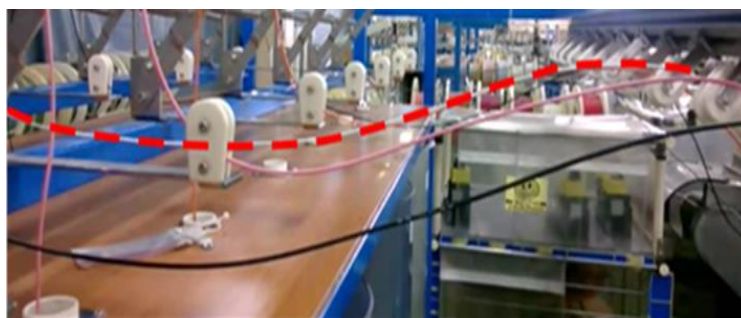
ภาพที่ 16 แสดงการแกว่งตัวของสายไฟระหว่างการตัด ระดับที่ 1
