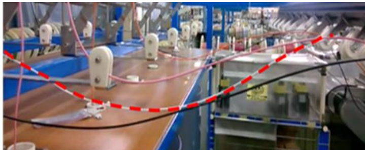
ภาพที่ 18 แสดงการแกว่งตัวของสายไฟระหว่างการตัด ระดับที่ 3
