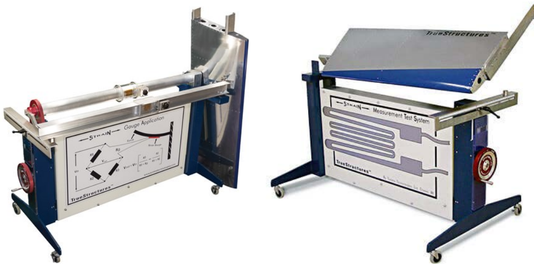
รูปที่ 1 ชุดทดลองการวิเคราะห์ความเครียดของโครงสร้างที่เป็นชุดทดลองเชิงพาณิชย์ [19]
