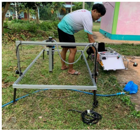
รูปที่ 7 โครงสร้างชุดต้นแบบระบบปลูกและรดน้ำผักอัตโนมัติสำหรับผู้สูงวัย
