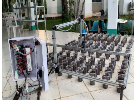
รูปที่ 9 ต้นแบบระบบปลูกและรดน้ำผักอัตโนมัติสำหรับผู้สูงวัยทำการปลูกเมล็ดผักทั้ง 3 ชนิด
