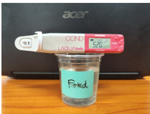
รูปที่ 7 แสดงการเก็บตัวอย่างน้ำ (ก) และ ผลการตรวจวัดคุณภาพน้ำป้อนและน้ำโบลว์ดาวน์ (ข)
