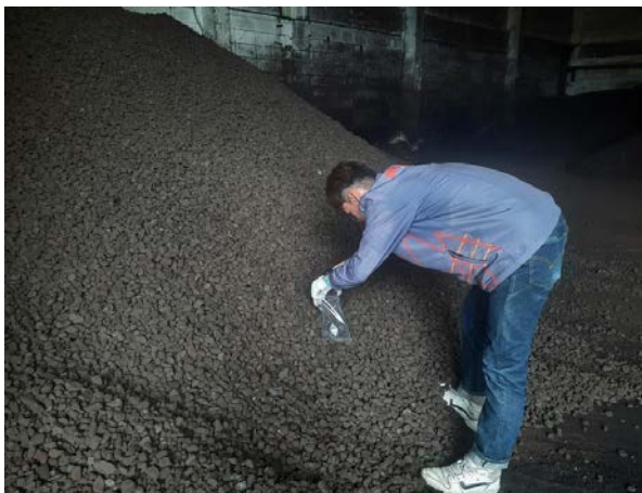
รูปที่ 4 แสดงเชื้อเพลิงถ่านหินปิทูมินัสและเชื้อเพลิงชีวมวลไม้แบบผงที่ใช้ในการทดสอบ
