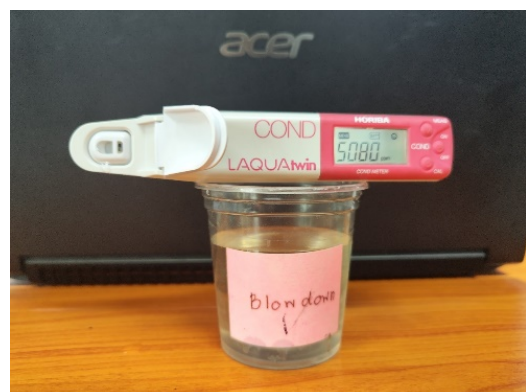
รูปที่ 7 แสดงการเก็บตัวอย่างน้ำ (ก) และ ผลการตรวจวัดคุณภาพน้ำป้อนและน้ำโบลว์ดาวน์ (ข)
