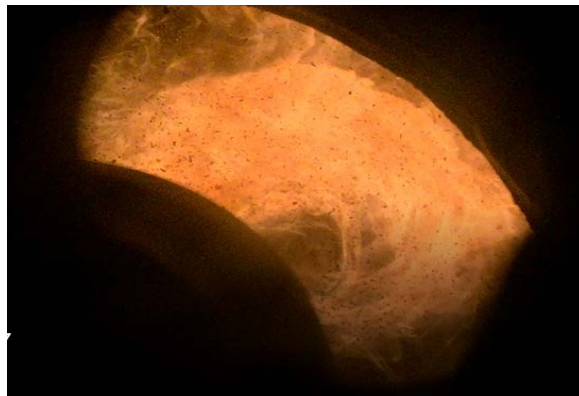
รูปที่ 7. ลักษณะการเผาไหม้เชื้อเพลิงชีวมวลที่ติดตั้งวัตถุขวางการไหลที่ระยะ 20 mm
