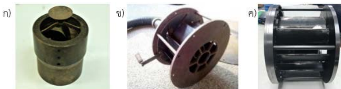
รูปที่ 1 (ก) การติดตั้งวัตถุขวางการไหล (ข) อุปกรณ์สร้างการไหลหมุนควงชนิดใบตรง (ค) อุปกรณ์สร้างการไหลหมุนควงชนิดใบโค้ง
