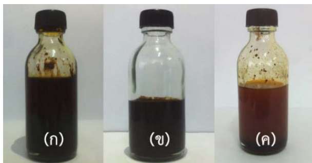
รูปที่ 5 น้ำมันชีวภาพจากชุดควบแน่น (ก) น้ำหล่อเย็น (ข) เครื่องตกตะกอนไฟฟ้าสถิตย์ (ค) น้ำแข็งผสมเกลือ
