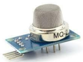
ภาพที่ 2 โมดูลเซ็นเซอร์ตรวจจับความเข้มข้นของแก๊ส (MQ-2)
