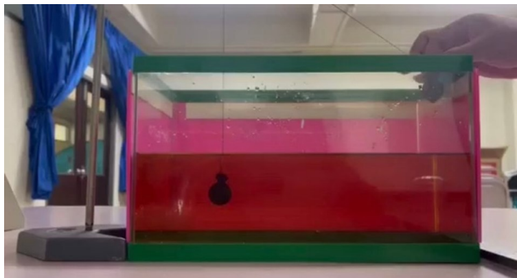
ภาพที่ 1: การจัดตั้งอุปกรณ์สำหรับศึกษาการชนกันของวัตถุในของเหลว
