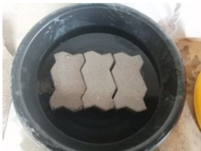
ภาพที่ 5: แสดงการแช่อิฐตัวอย่าง เพื่อหาค่าอัตรา การดูดซึมน้ำ
