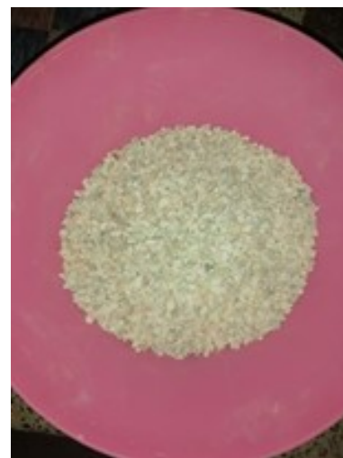
ภาพที่ 2: แสดงการตากไล่ความชื้นของเกล็ดหินอ่อน
