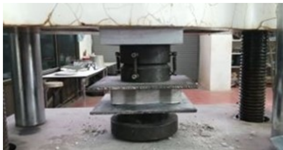
ภาพที่ 6: ตัวอย่างทดสอบบนเครื่องทดสอบ การรับแรงอัด
