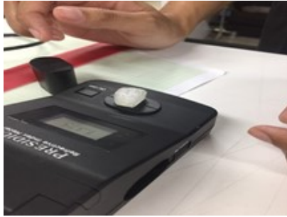
ภาพที่ 2: เครื่องวัดดัชนีหักเห ยี่ห้อ PRESIDIUM รุ่น Refractive Index Meter II
