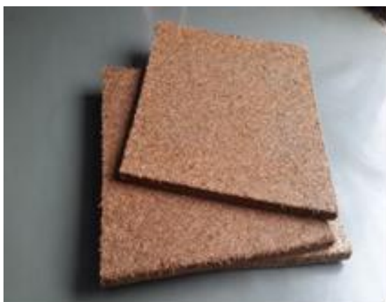
ภาพที่ 1 แผ่นใยไม้อัดจากเส้นใยมะพร้าวผสมเส้นใยต้นรูปถั่วเขียว
