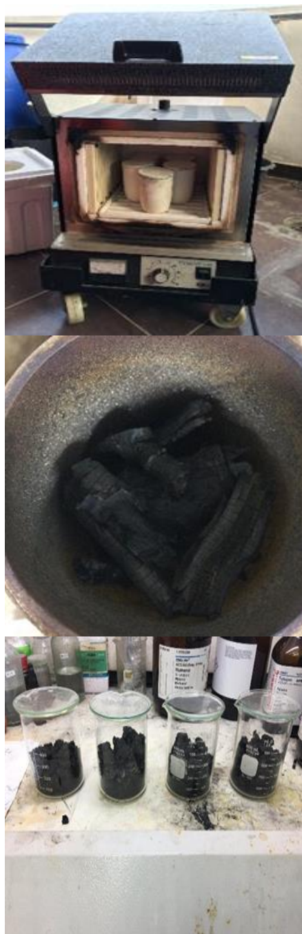
ภาพที่ 1 อุปกรณ์ในการสังเคราะห์ถ่านกัมมันต์จากกะลามะพร้าว
