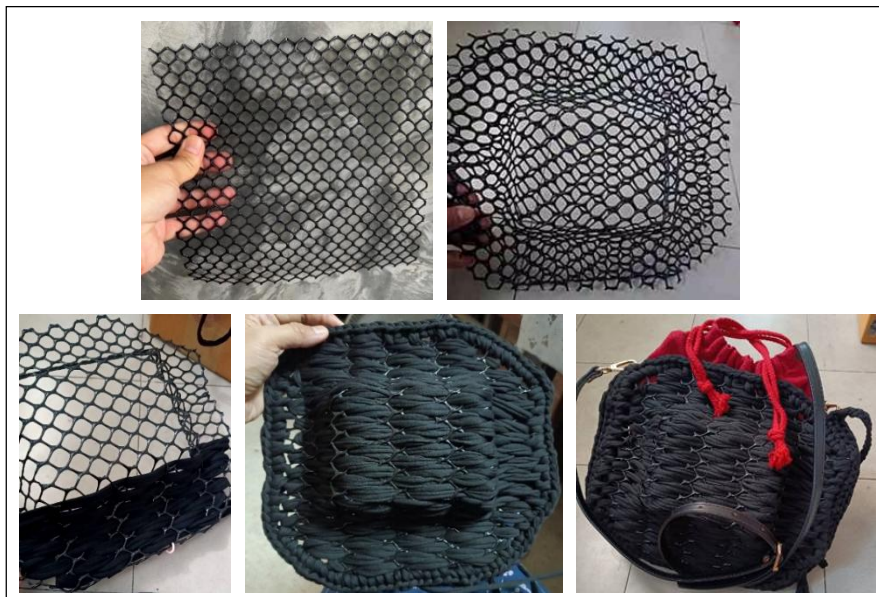
ภาพที่ 5 ตัวอย่างขั้นตอนการทำผลิตภัณฑ์กระเป๋าวัสดุพลาสติกโพลีเอทิลีน
