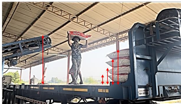
ภาพที่ 2 ความสูงของการจัดเรียงกระสอบปุ๋ยที่ซ้อนกันในแต่ละชั้น โดยส่งผลต่อระยะการยก (Distance of Lift) ซึ่งคิดจากผลต่างของระดับความสูงที่ต้นทางและปลายทาง
