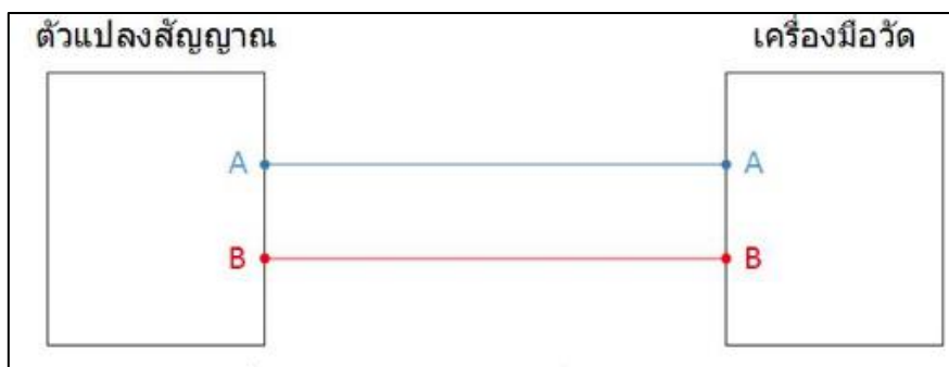
ภาพที่ 3 การเชื่อมต่อ RS485 ระหว่างมือวัดกับตัวแปลงสัญญาณ
