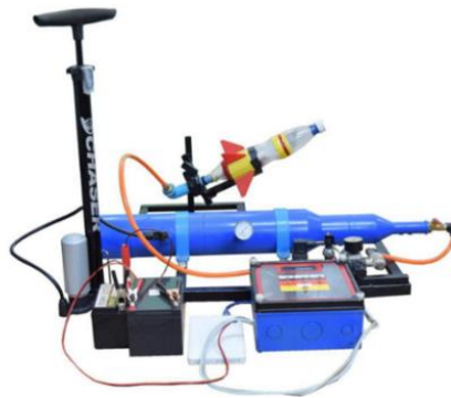
ภาพที่ 1 ชุดทดลอง การเคลื่อนที่แบบโพรเจกไทล์ โดยการควบคุมความดันของฐานยิงจรวดขวดน้ำด้วยวงจร Arduino ที่มา: ภาพถ่ายโดย นางสาวรัชฎา ศรีจันทร์ เมื่อวันที่ 6 เดือน กันยายน พ.ศ. 2562
