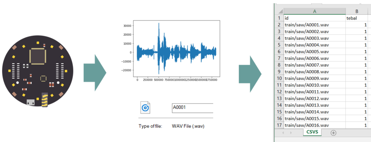
ภาพที่ 3 แสดงการรับสัญญาณเสียงด้วย ReSpeak Mic Array
