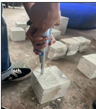
ภาพที่ 2 การทดสอบตัวอย่างด้วย Rebound Hammer
