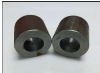
(ก) กำหนดขนาดของชิ้นงานทดสอบ (ข) ชิ้นงานที่ผ่านกระบวนการเตรียมเพื่อทดสอบ (ค) การกลึงชิ้นงาน
