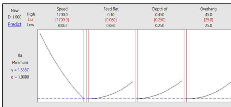
รูปที่ 7 สถานะที่เหมาะสมของปัจจัยในการกลึงคว้านรูในเหล็กกล้าคาร์บอนเกรด S45C
