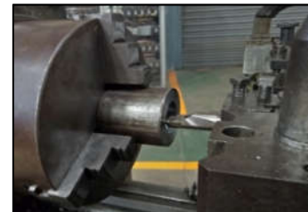
(ก) กำหนดขนาดของชิ้นงานทดสอบ (ข) ชิ้นงานที่ผ่านกระบวนการเตรียมเพื่อทดสอบ (ค) การกลึงชิ้นงาน
