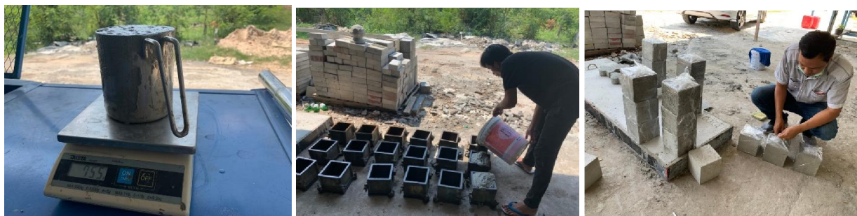
ก) หาหนาแน่นของคอนกรีตสด ข) เทคอนกรีตลงแบบหล่อ ค) การบ่มชื้นโดยใช้พลาสติกหุ้ม รูปที่ 4 ตัวอย่างคอนกรีตหลังถอดออกจากแบบหล่อ
