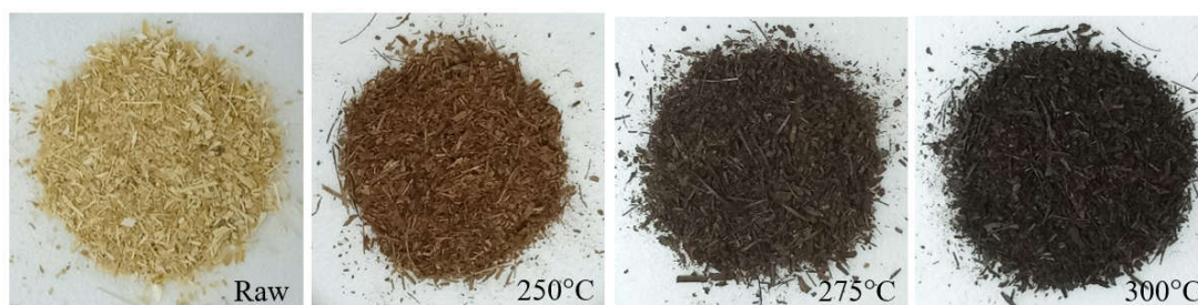
รูปที่ 3 ลักษณะทางกายภาพของชีวมวลข้าวโพดภายหลังการปรับปรุงที่อุณหภูมิ 250, 275 และ 300 องศาเซลเซียส
