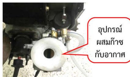
รูปที่ 6 อุปกรณ์ผสมก๊าซกับอากาศ
