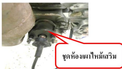
รูปที่ 11 ชุดห้องเผาไหม้เสริมติดตั้งแทนที่ในตำแหน่งของหัวฉีดน้ำมันดีเซล
