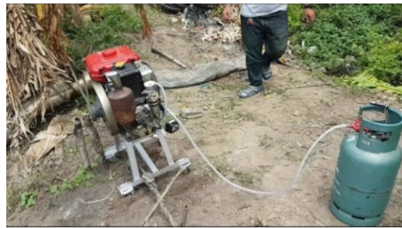
รูปที่ 17 ใช้งานเครื่องยนต์ Yanmar TF120DI เป็นต้นกำลังในการสูบน้ำ
