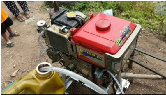
รูปที่ 17 ใช้งานเครื่องยนต์ Yanmar TF120DI เป็นต้นกำลังในการสูบน้ำ
