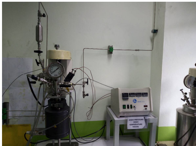
รูปที่ 1 เครื่องปฏิกรณ์ที่ใช้ในการเกิดปฏิกิริยาไดออกซิเจนเนชัน
