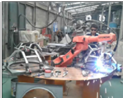
รูปที่ 10 การติดตั้งและการเชื่อมด้วยหุ่นยนต์
