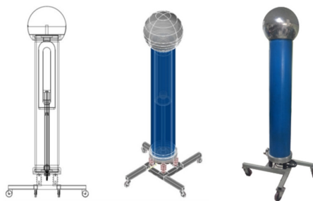
รูปที่ 2 โครงสร้างตัวเก็บประจุอัดก๊าซ SF_6 ที่สร้างเสร็จแล้ว
