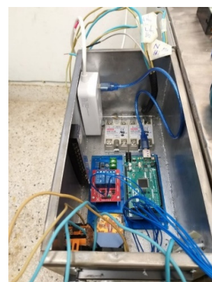
รูปที่ 7 ติดตั้งแท่งความร้อนอินฟราเรดภายในเครื่องอบ รูปที่ 8 ติดตั้งวงจรระบบควบคุมการทำงานของเครื่องอบ
