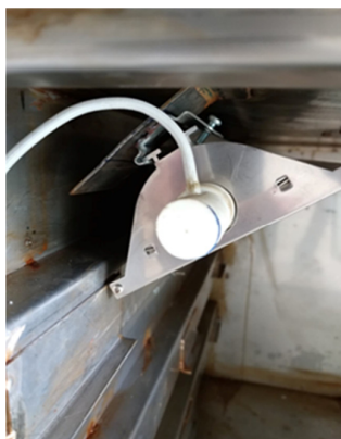
รูปที่ 7 ติดตั้งแท่งความร้อนอินฟราเรดภายในเครื่องอบ รูปที่ 8 ติดตั้งวงจรระบบควบคุมการทำงานของเครื่องอบ
