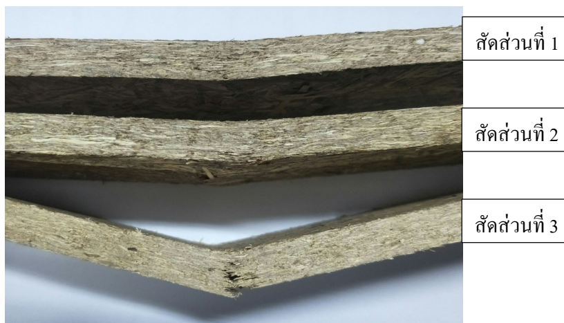
รูปที่ 7 ลักษณะการเสียรูปของชิ้นทดสอบเมื่อทดสอบความต้านทานแรงดัด
