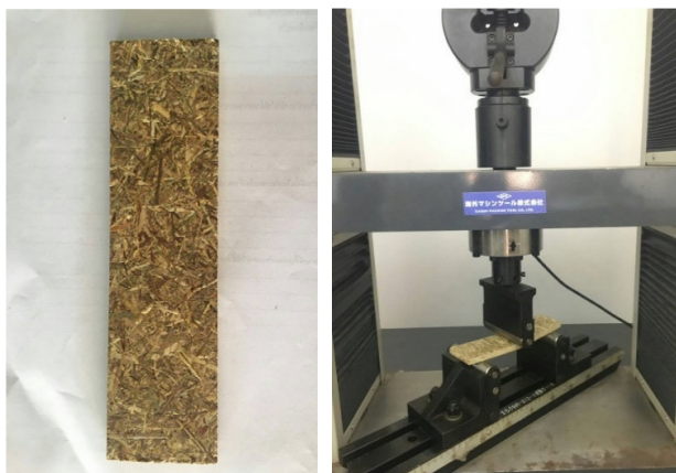
รูปที่ 3 การทดสอบค่าความต้านแรงดัดและค่าโมดูลัสความยืดหยุ่น
