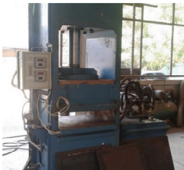
รูปที่ 1 เครื่องฮีตร้อนไฮโดรลิก 3 เฟส กำลังอัด 30 ตัน
