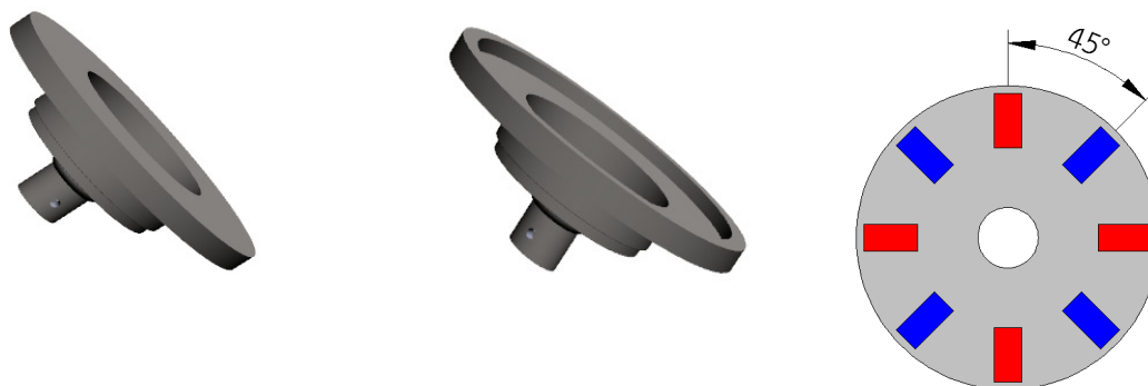
(ก) ลักษณะของมอเตอร์ (ข) ลักษณะของมอเตอร์ที่กลึงเสร็จ (ค) ลักษณะการวางขั้วแม่เหล็ก รูปที่ 3 การออกแบบมอเตอร์ด้านข้าง
