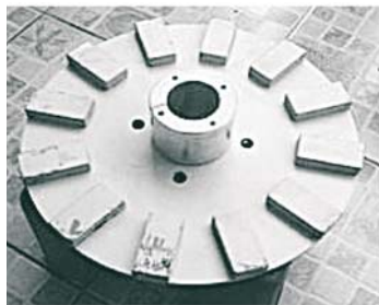
รูปที่ 4 ตัวอย่างโรเตอร์ชนิดแม่เหล็กถาวร
