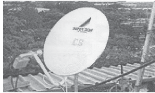
รูปที่ 3 จานสายอากาศรับสัญญาณดาวเทียม มี LNB ติดตั้งอยู่หน้าจาน
