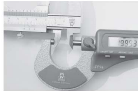
รูปที่ 8 ไมโครมิเตอร์สอบเทียบปากวัดใน
