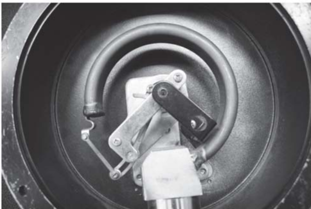
รูปที่ 3 โครงสร้างของเกจวัดความดัน
