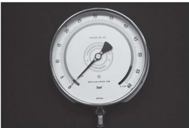
รูปที่ 6 เกจวัดความดันมาตรฐานแบบมีจุดหยุดเข็ม
