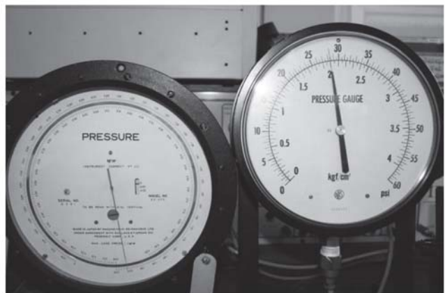
รูปที่ 15 การสอบเทียบเกจวัดความดันด้วยเกจมาตรฐานแบบลม
