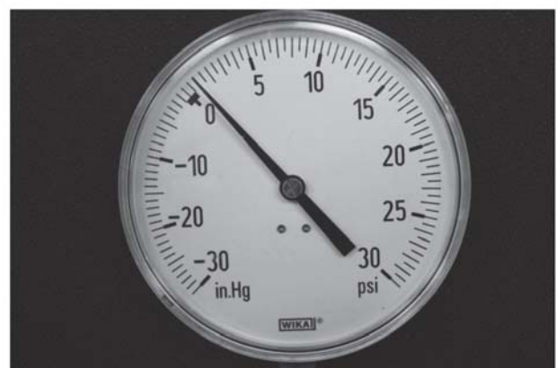
รูปที่ 8 เกจวัดความดันแบบ Compound gauge
