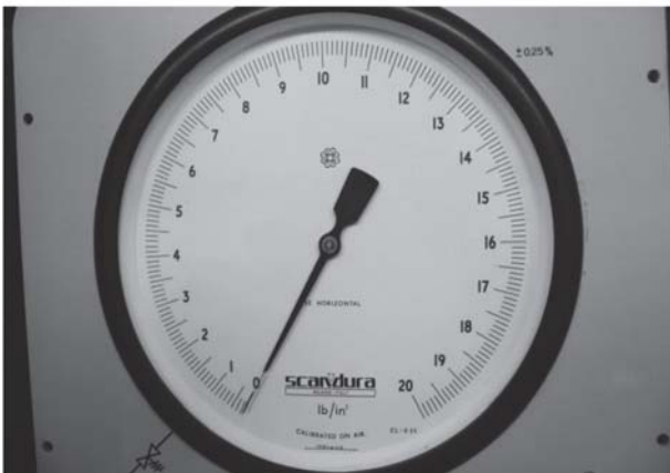
รูปที่ 5 เกจวัดความดันมาตรฐานแบบลมติดตั้งแบบนอน
