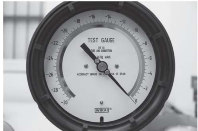
รูปที่ 7 เกจวัดความดันมาตรฐานแบบความดันลบ
