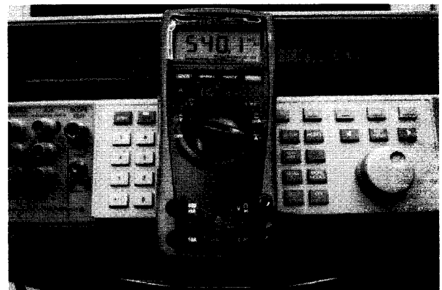
รูปที่ 6 การสอบเทียบ AC voltmeter
