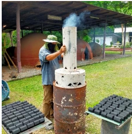
ภาพที่ 1 เตาถ่านน้ำมัน 200 ลิตร แบบไร้ควันของกรมป่าไม้
