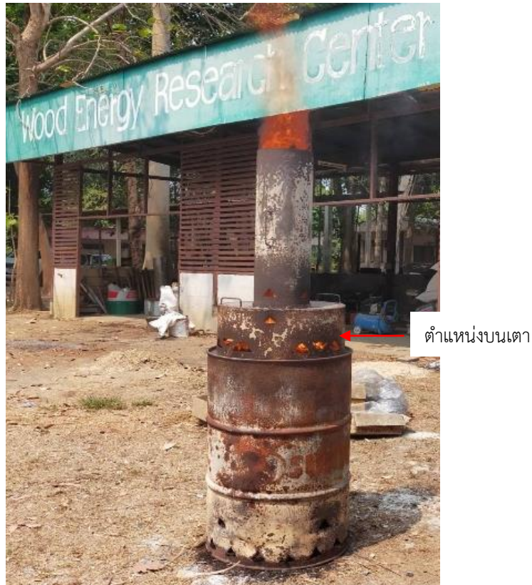
ภาพที่ 2 ตำแหน่งที่วัดอุณหภูมิของเตาเผาถ่าน
