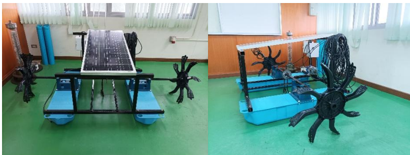
ภาพที่ 2 กังหันน้ำเติมอากาศที่ได้ออกแบบสร้าง
