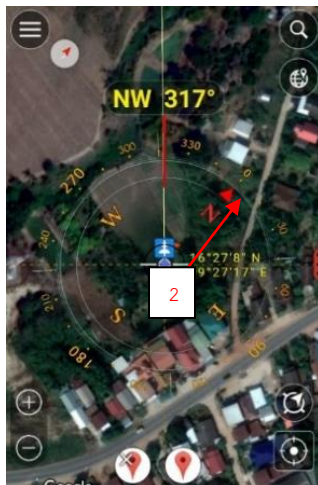
ภาพที่ 7 ณ จุดติดตั้งจานรับสัญญาณหันทิศทางไปยังเสาส่งที่ลือคไว้ ให้เส้นสีแดงทับกับเส้นสีเหลืองตามตำแหน่งหมายเลข 2
