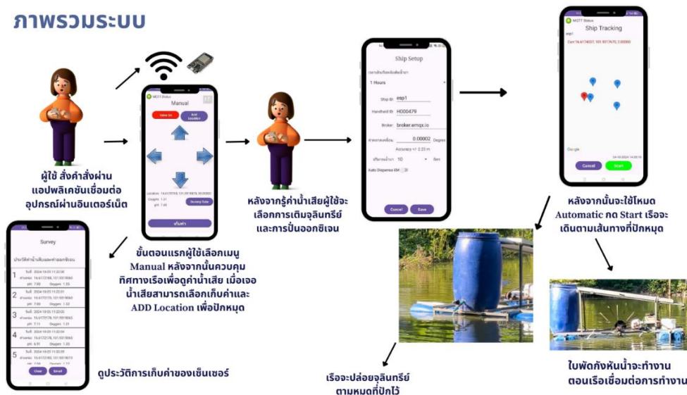
ภาพที่ 3 ภาพรวมระบบเรือบำบัดน้ำเสีย
