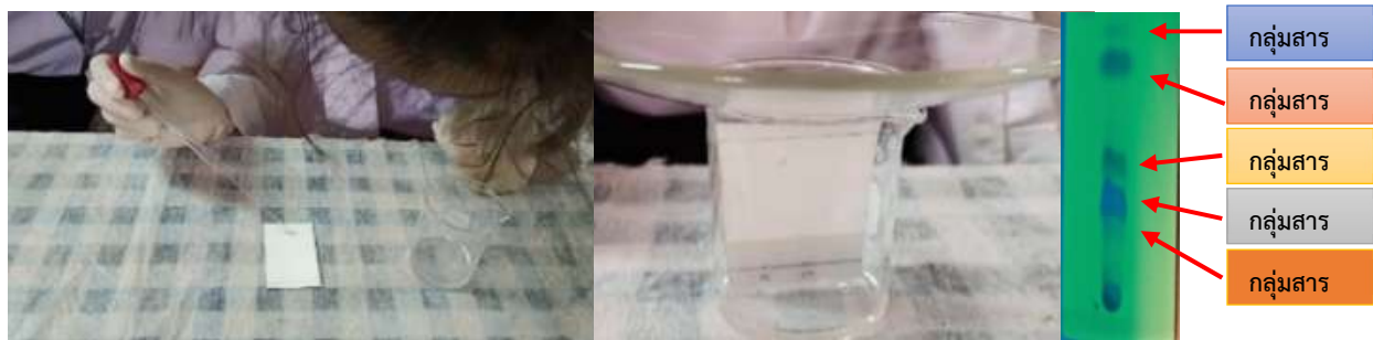
ภาพที่ 2 ผลการตรวจองค์ประกอบเบื้องต้นโดยเทคนิคโครมาโทกราฟีแบบกระดาษ (Thin Layer Chromatography, TLC)
