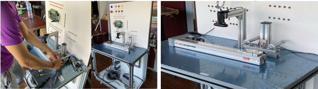
รูปที่ 2 การประกอบติดตั้งโครงสร้าง (ก) การติดตั้งชุดเซอร์โวมอเตอร์และชุดคัตแยก (ข) การติดตั้งชุดเซอร์โวมอเตอร์และชุดกล่องเว็บแคม
